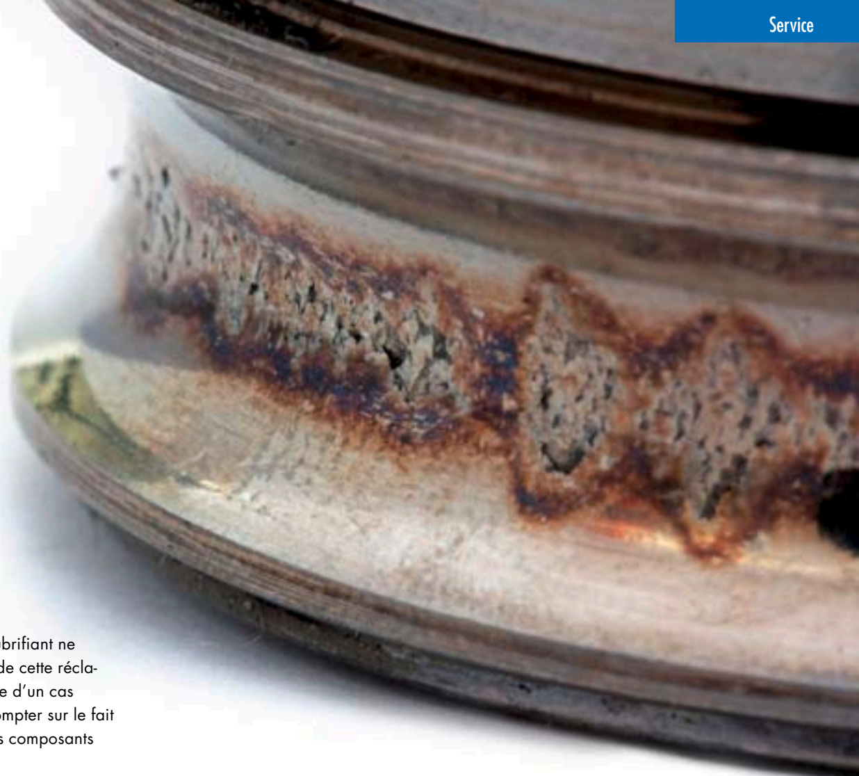
Figure 3: L'absence de lubrifiant est la cause du défaut.
