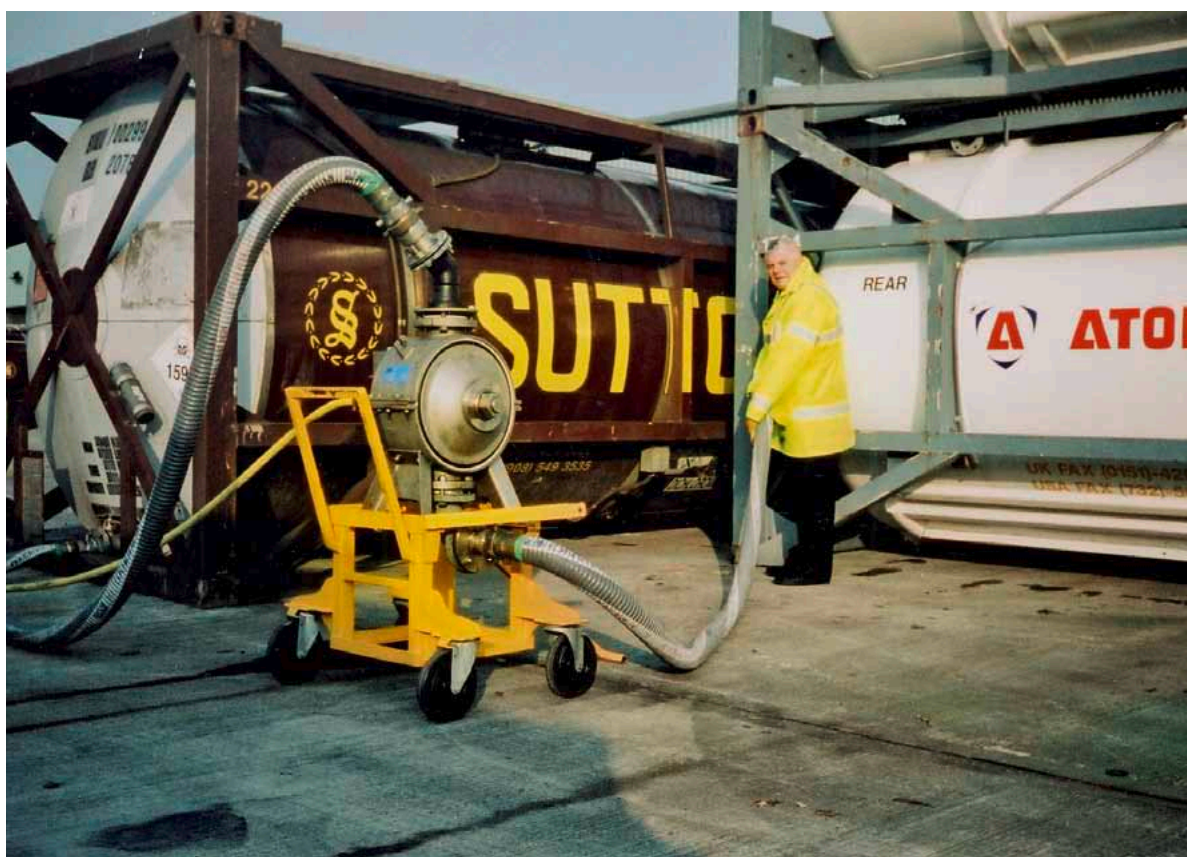
La pompe traite différents liquides, ex. : diesel. Elle peut vider un camion-citerne de 30 000 litres en moins de deux heures.
