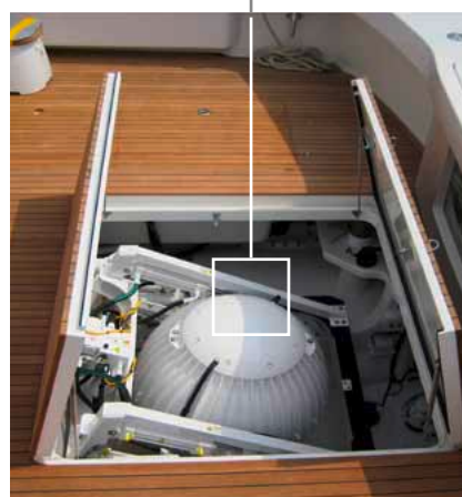
Les gyroscopes sont capables d'amortir les mouvements de roulis et de houle d'un bateau.
