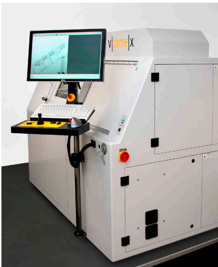
Le tomographe informatique permet une représentation tridimensionnelle à l'intérieur d'un composant.
